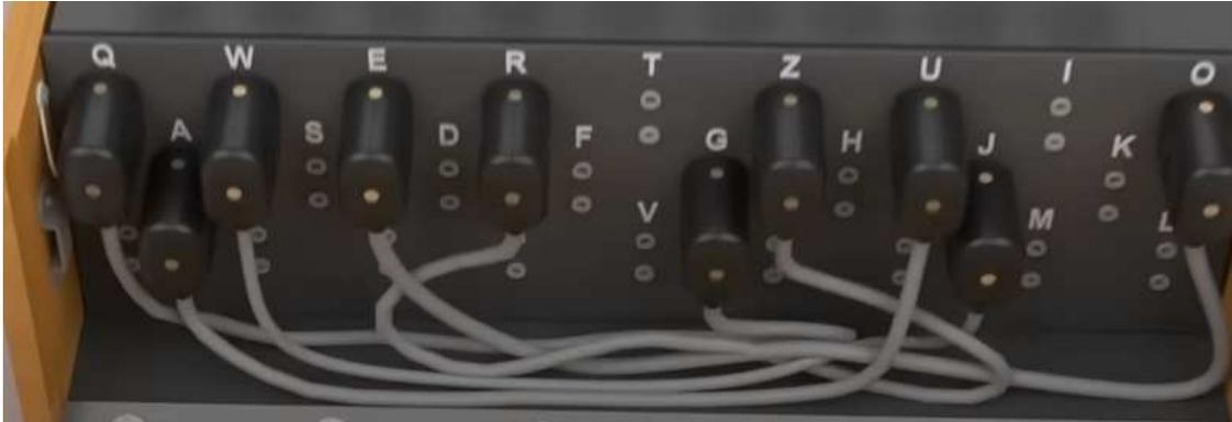
Il s'agit d'un panneau situé à l'avant de la machine, sur lequel l'opérateur pouvait brancher des câbles pour connecter des paires de lettres. En branchant des câbles sur le plugboard, l'opérateur pouvait échanger la place de certaines lettres avant qu'elles ne passent à travers les rotors, augmentant ainsi encore la complexité du chiffrement.
