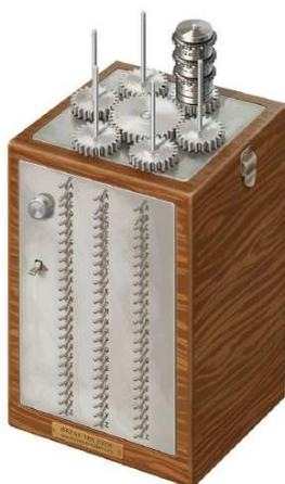
Pour déchiffrer les messages codés, la "Bomba" utilisait une méthode appelée "attaque par force brute". Cela impliquait d'essayer toutes les combinaisons possibles de réglages de la machine Enigma jusqu'à ce que le bon réglage soit trouvé.
