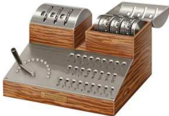
Le cyclomètre était une machine électromécanique utilisée par les cryptanalystes polonais pour casser Enigma. Il a été inventé par Marian Rejewski en 1932.
