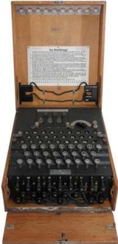
Enigma se présentait sous la forme d'une boîte rectangulaire d'environ 30 cm de long sur 15 cm de large et 10 cm de haut, avec un couvercle amovible. Elle avait un clavier avec les 26 lettres de l'alphabet, une série de rotors fixés sur un axe, un tableau de connexions et un plugboard à l'avant de la machine.
