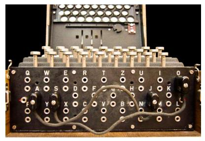
Un câblage manuel a été rajouté à Enigma par l'armée allemande en 1930 pour renforcer la force cryptographique de la machine. Le câblage permet d'échanger jusqu'à 13 paires de lettres entre elles. Généralement, 10 paires de lettres étaient échangées donc 6 lettres restaient identiques. Le câblage manuel permet d'avoir  $26! / (6! * 10! * 2^{10}) = 151 * 10^{12}$  possibilités différentes (résultat arrondi).
