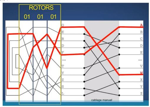
Avec les positions de rotos 1-1-1 et le câblage manuel fait, la lettre A en entrée devient W et inversement.
