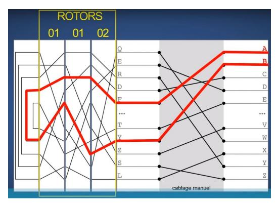
Avec cette position, la lettre A en entrée devient B et inversement car même si le câblage manuel reste le même, le dernier rotor s'est décalé de 1.
