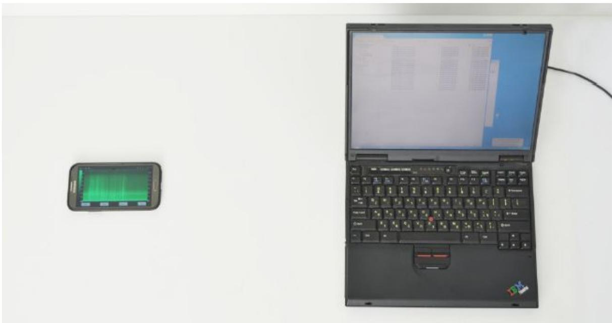
*dispositif minimal utilisant le micro d'un smartphone, placé en direction de la ventilation de l'ordinateur, l'attaque est possible jusqu'à 30cm de distance*
