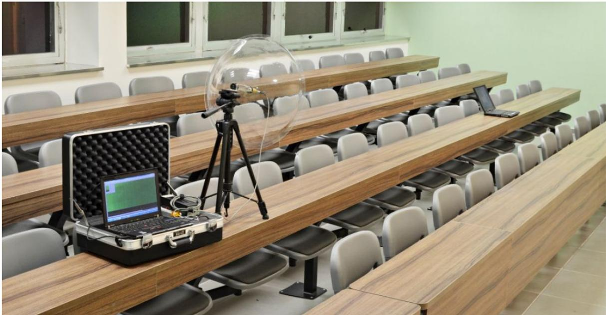
*Dispositif utilisant un micro parabolique, l'attaque marche jusqu'à 4 mètres*
